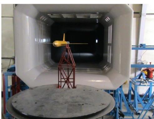
شکل ۴- نصب مدل کنترلی بر روی استند استاتیکی شبیه ساز زمین در  $H/b=1.7$
