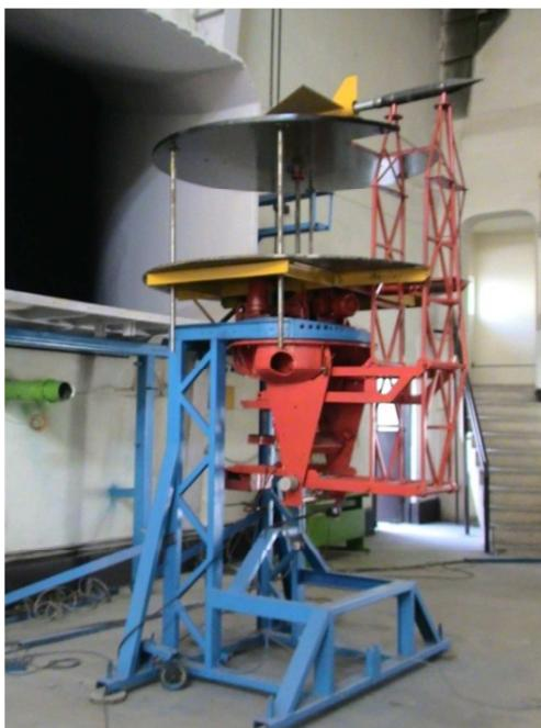
شکل ۳- نصب مدل هوایی بال مثلثی بر روی استند شبیه ساز زمین
