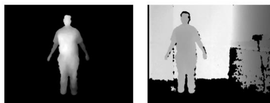
شکل ۴: الف) تصویر عمق خام، ب) تصویر بعد از پیش‌پردازش
