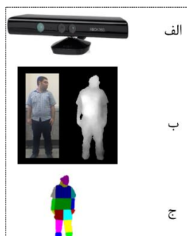
شکل ۱: (الف) دستگاه کینکت، (ب) تصاویر رنگی و عمق، (ج) تقسیم‌بندی اجزای بدن
