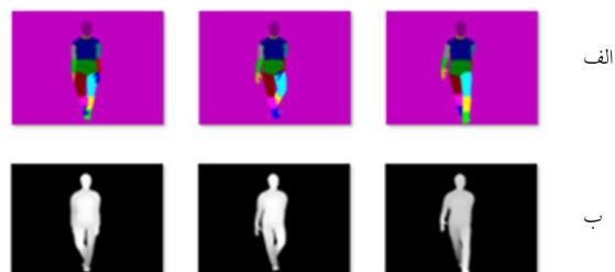
شکل ۲: تصاویر عمق و برجسب‌های بدن، (الف) برجسب‌های بدن، (ب) تصاویر عمق
