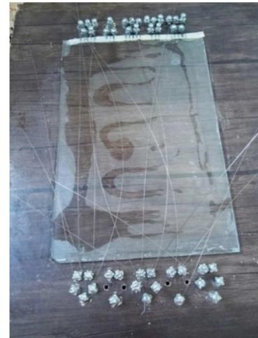
شکل ۱- نمایی از فیکسچر ساخت و نحوه بستن سیم‌ها
