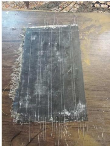
شکل ۲- نمایی از صفحه ساخته شده قبل از برش
