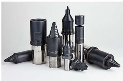
شکل ۱- ابزار در جوشکاری اصطکاکی اغتشاشی [۴].
