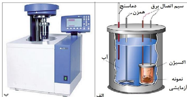
شکل ۲- الف: دستگاه بمب کالری‌متر استفاده شده و جزئیات آن ب: تصویر کلی دستگاه کالری‌متر
