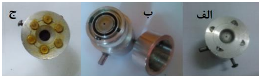
شکل ۲- افشانک‌های کمک هوا ساخته شده، (الف) نوع اول (ALA)، (ب) نوع دوم (LA) و (ج) نوع سوم (LAL)
