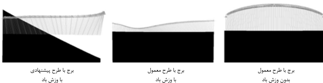
شکل ۹- بردارهای سرعت در دهانه خروجی برج
