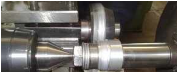
شکل ۱- فرآیند فلوفرمینگ روی دستگاه تراش
