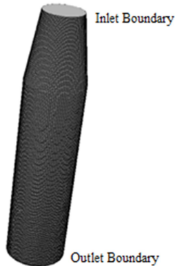
شکل ۲- هندسه دیفیوزر مستقیم درفت تیوب
