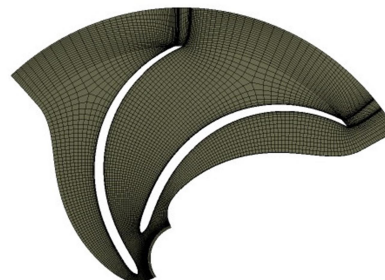
شکل ۱۹- سطح مقطع پروانه با ضخامت ۵ میلی‌متر در ارتفاع متوسط
