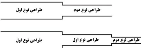
شکل ۴- انواع طراحی در یک مبادله‌کن گرمایی سه جریانی لوله‌ای با ساختار درختی دارای دو و سه ساختار
