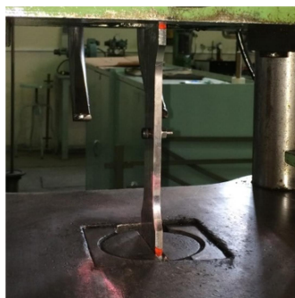
شکل ۷- نحوه بسته شدن نمونه‌های آزمایشی بر روی دستگاه خستگی
