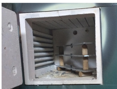
شکل ۵- قرار گرفتن نمونه‌ها در کوره
