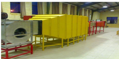
شکل ۱- نمایی از تونل باد آزمایشگاه
