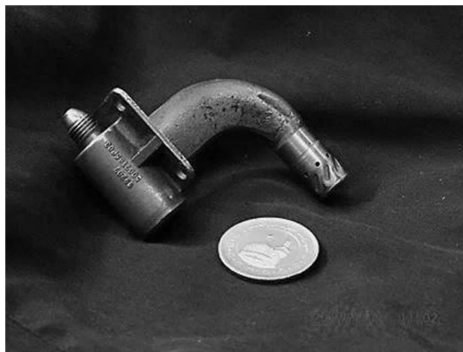
شکل ۵- انژکتور فشاری-پیچشی دوگانه مورد آزمایش
