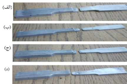
شکل ۸- شکست در نمونه‌های ۲ میلی‌متر به ۴ میلی‌متر: (الف) آفست ۰/۶۵ میلی‌متر در ورق نازک‌تر (ب) آفست ۰/۵ میلی‌متر در ورق نازک‌تر (ج) آفست ۰/۳ میلی‌متر در ورق نازک‌تر (د) آفست صفر
