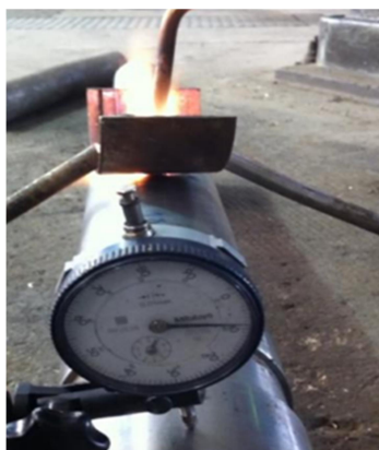
شکل ۵- گرمایش آزمایشی محور
