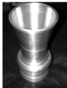
شکل ۱۱- نازل تراش داده شده موتور
