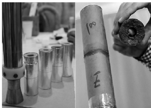
شکل ۱۲- اتصال گرین‌ها و بارگذاری در موتور
