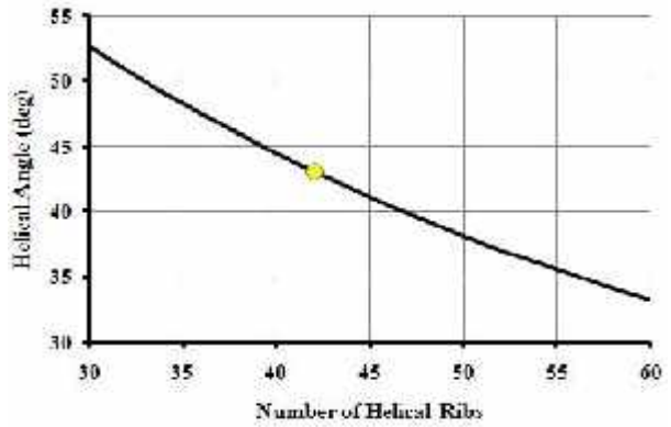
شکل ۱۱- تغییرات ابعادی ریب‌های مارپیچی و دایره‌ای سازه مشبک استوانه‌ای با افزایش تعداد ریب‌های مارپیچی
