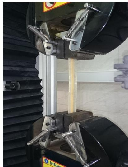
شکل ۳- نحوه انجام آزمون کشش بر روی نمونه کامپوزیتی
