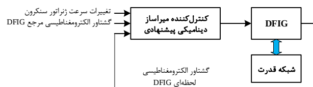
شکل ۵: بلوک دیاگرام عملکرد کنترل کننده پیشنهادی
