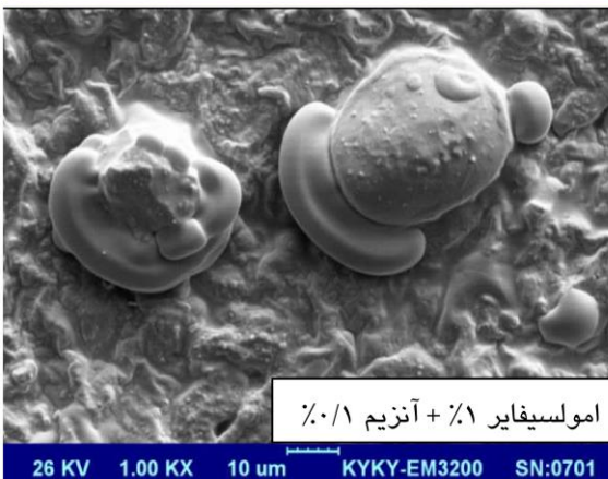
ادامه شکل ۵- تصاویر میکروسکوپ الکترونی روبشی (SEM) نمونه‌های حاوی امولسیفایر و یا آنزیم در بزرگنمایی ۱۰۰۰
