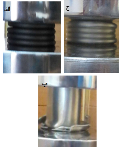
شکل ۸- آزمون لهیدگی لوله‌های تک لایه، الف- فولاد، ب- آلومینیوم، ج- آلومینیوم آنیل شده
