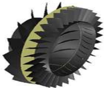
شکل ۶ - نمای صفحه اختلاطی بین روتور و استاتور در یک مرحله از کمپرسور
