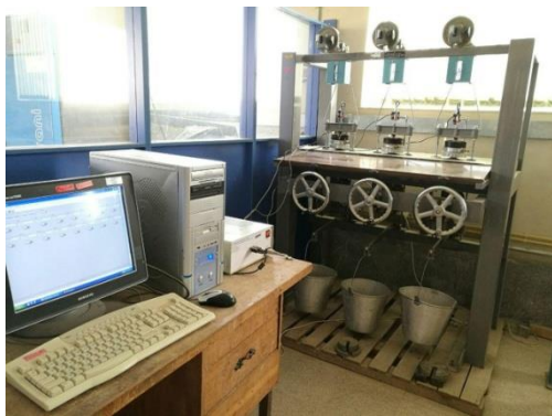
شکل ۱- دستگاه تحکیم یک بعدی و دیتالاگر
