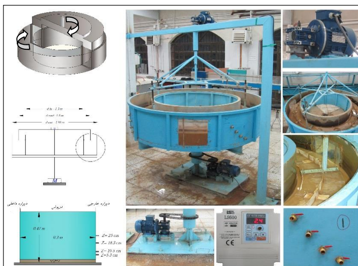
شکل ۲- نمایی از اجزای فلوم دایره‌ای مورد استفاده
