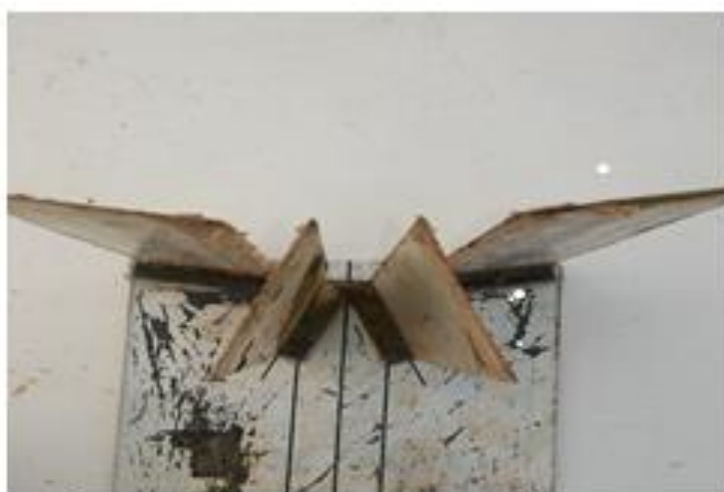
شکل ۲- آرایش شعاعی صفحات مستغرق در آزمایش‌ها.
