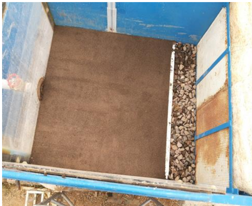
شکل ۱- نمایشی از مخزن رسوبات همراه با صفحه آرام‌کننده جریان و بستر رسوبی.
