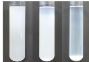
شکل ۳- پایداری نانوسیال آب-سیلیکای ۰/۸٪ حجمی در زمان های مختلف. الف) لحظه ساخت. ب) ۱۰ روز بعد. پ) ۲۵ روز بعد
