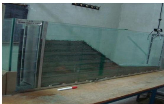
شکل ۱۰- ساخت شیروانی مسلح با ستون سنگی
