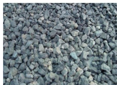
شکل ۴- شن مورد استفاده در ساخت ستون سنگی
