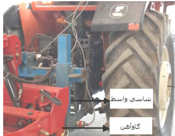
شکل ۵- شاسی واسط پین‌های اندازه‌گیری نیرو و سامانه اتصال- سه‌نقطه تراکتور
