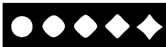
شکل ۲- تأثیر پارامتر w بر گوشه‌های گشودگی شبه مربعی
