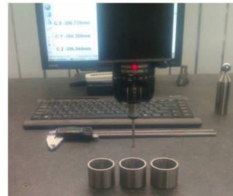
شکل ۳- اندازه‌گیری ابعاد بوش توسط ماشین اندازه‌گیری مختصات
