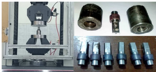
شکل ۱۴- محور و بوش سرهم بندی شده و فیکسچر مورد استفاده جهت اندازه گیری تجربی نیروی استخراج محور به همراه پرس یونیورسال
