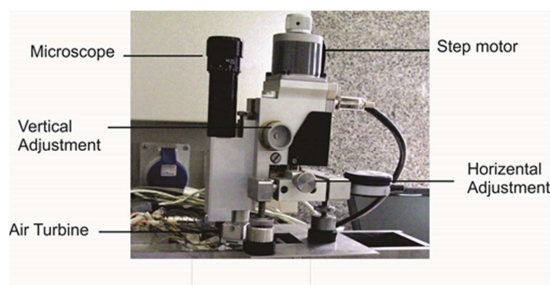
شکل ۳- دستگاه استفاده شده برای سوراخ زنی مرحله ای با دقت بالا
