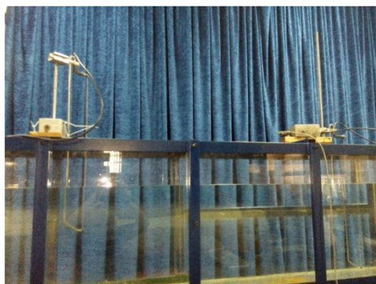
شکل ۲- نصب حسگرهای ارتفاع سنج موج بر روی کانال
