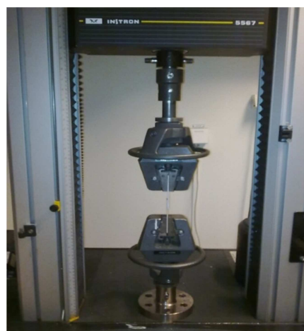
شکل ۳- آزمون کششی - برشی نمونه های آماده شده
