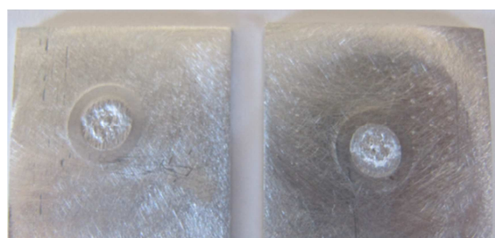
شکل ۵- شکست نمونه های جوشکاری شده از ناحیه اتصال
