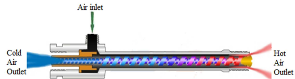
شکل ۱- دستگاه لوله گردابه‌ای و نحوه عملکرد آن [۱]
