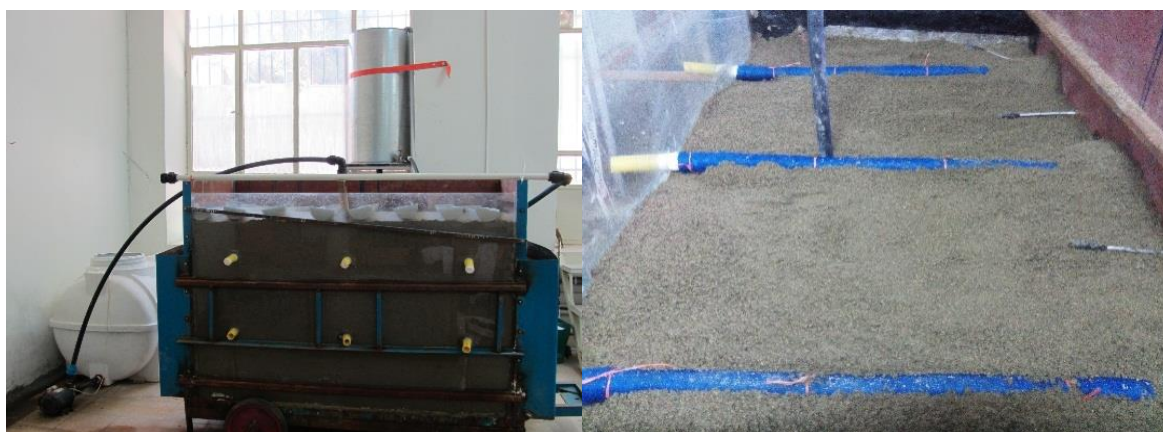
شکل ۱- نمای کلی مدل و نصب لوله‌های زهکش‌ها.
