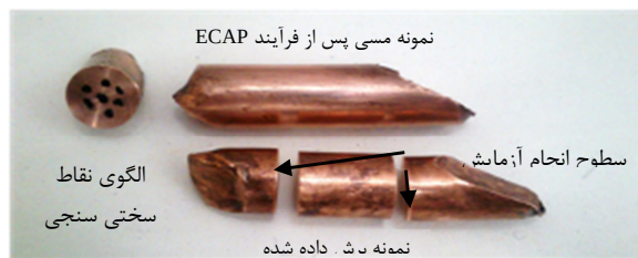
شکل ۴- نحوه‌ی برش نمونه‌های ECAP شده و الگوی نقاط سختی سنجی
