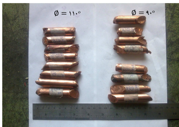
شکل ۳- نمونه های مسی تولید شده به روش ECAP توسط قالب های \phi = 90^\circ و \phi = 110^\circ .
