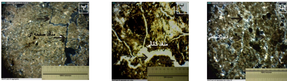
شکل ۱- (الف، ب، پ): A 2 شدت ۳۷ mm/h، ۳cm-۱/۵- بی فابریک خطی- منافذ کانالی- (PPL)، (XPL)، ۴۰X- (پ)- A 2 شدت ۳۷mm/h، ۳cm-۱/۵- بی فابریک غیر کریستالیک شبکه‌ای و اصلی- منافذ صفحه‌ای- (XPL)، ۴۰ X.
