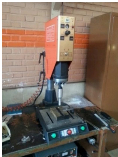
شکل ۳- شیپورک و دستگاه جوشکاری التراسونیک
