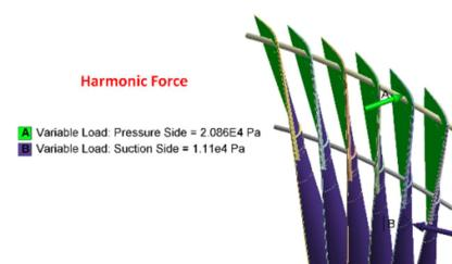
شکل ۵- نیروهای هارمونیک ناشی از فشار بخار
