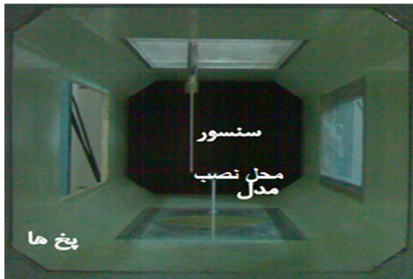
شکل ۵- اتاق آزمون تونل باد دانشگاه یزد به همراه سنسور و محل نصب مدل و نحوه رشد بیخ در گوشه دیواره‌ها
