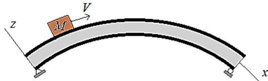
شکل ۱- تیر خمیده ساندویچی با تکیه گاه‌های ساده تحت جرم متحرک
