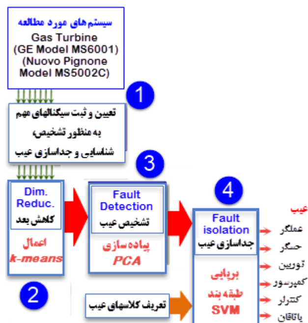
شکل ۷: شماتیک روش پیشنهادی تشخیص و جداسازی عیب.
