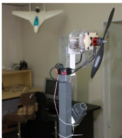
شکل ۳- دستگاه اندازه‌گیری پارامترهای مجموعه پیشران ساخته شده در آزمایشگاه ریز پهپاد ۱
