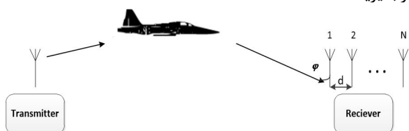
شکل ۱: مدل کانال SIMO در رادار
