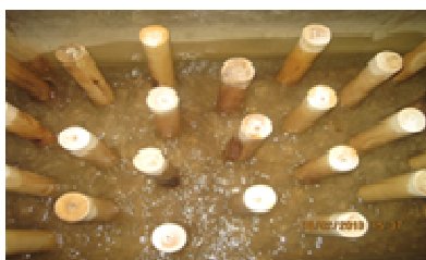
شکل 3- نمونه‌ای از نحوه قرارگیری موانع در فلوم.
