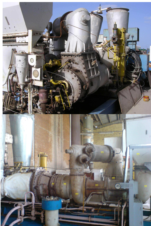
شکل ۱- نماهایی از توربین گاز Ruston TA-1750 و اجزای آن شامل: (۱): compressor turbine casing، (۲): C.T. inlet، casing، (۳): cross-over duct، (۴): air inlet duct، (۵): combustion chamber، (۶): air inlet casing، (۷): compressor outlet volute، (۸): compressor [۱۳]
