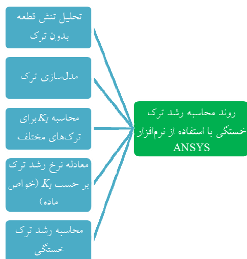
شکل ۳- فلوجارت روند محاسبه عمر رشد ترک خستگی پره توربین گاز با استفاده از نرم افزار ANSYS
