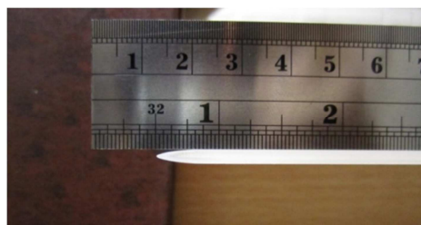
شکل ۴- استفاده از پروبیل بیضوی لبه حمله مدل پله
