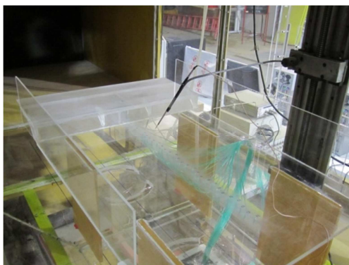
شکل ۶- وضعیت نصب پروب سیم داغ را در پایین دست مدل پله
