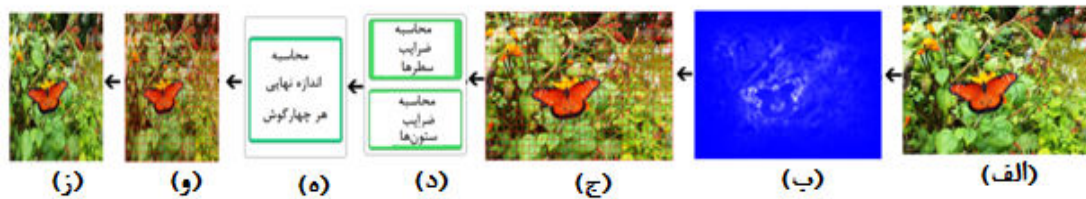
شکل ۲: شمای کلی الگوریتم پیشنهادی؛ (الف) تصویر اصلی، (ب) نقشه اهمیت (مرحله اول)، (ج) تصویر پوشیده شده با شبکه‌ای از چهارگوش‌ها (مرحله دوم)، (د) محاسبه ضرایب برای سطر و ستون‌ها (مرحله سوم)، (ه) محاسبه اندازه نهایی هر چهارگوش (مرحله چهارم)، (و) تصویر نهایی همراه با شکل تغییر یافته شبکه اولیه (مرحله پنجم) و (ز) تصویر خروجی
