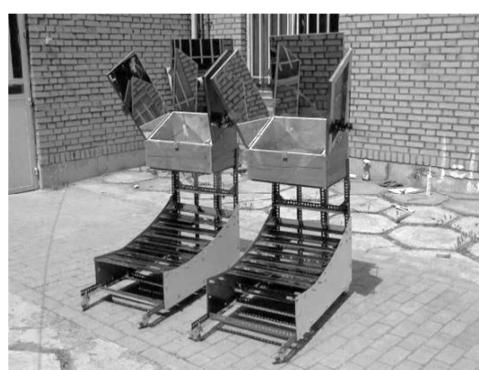
شکل ۱- تصویر دو نمونه اجاق خورشیدی آزمایشگاهی
